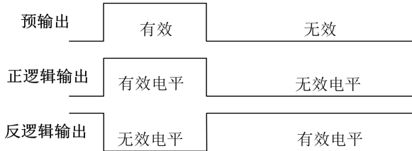
图 7- 15 数字输出端子正反逻辑输出示意图
